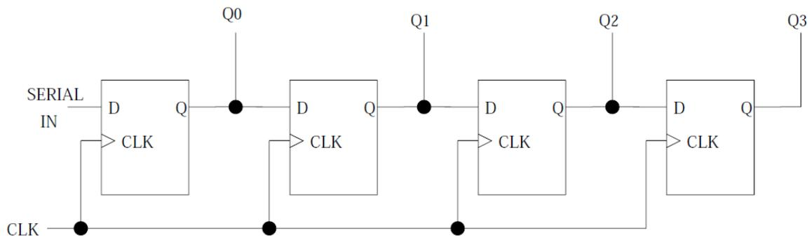
Figure : 4-bit shift register.
