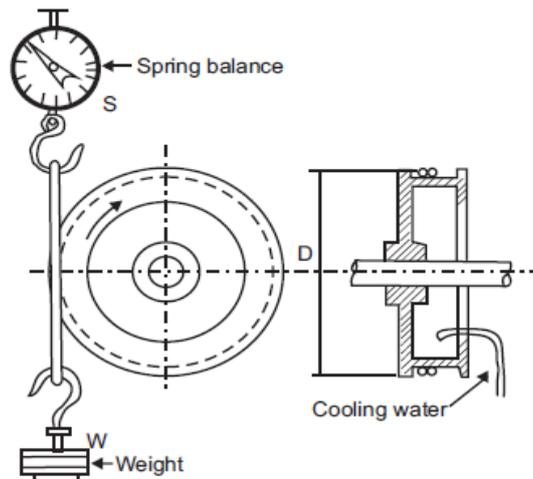
**Fig. 30. Rope brake**
