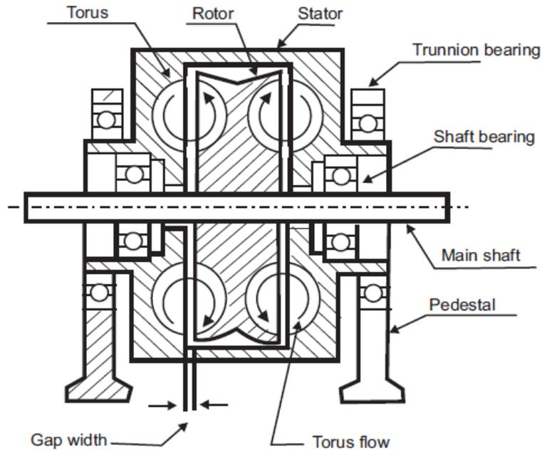
**Fig. 31. Hydraulic dynamometer**
