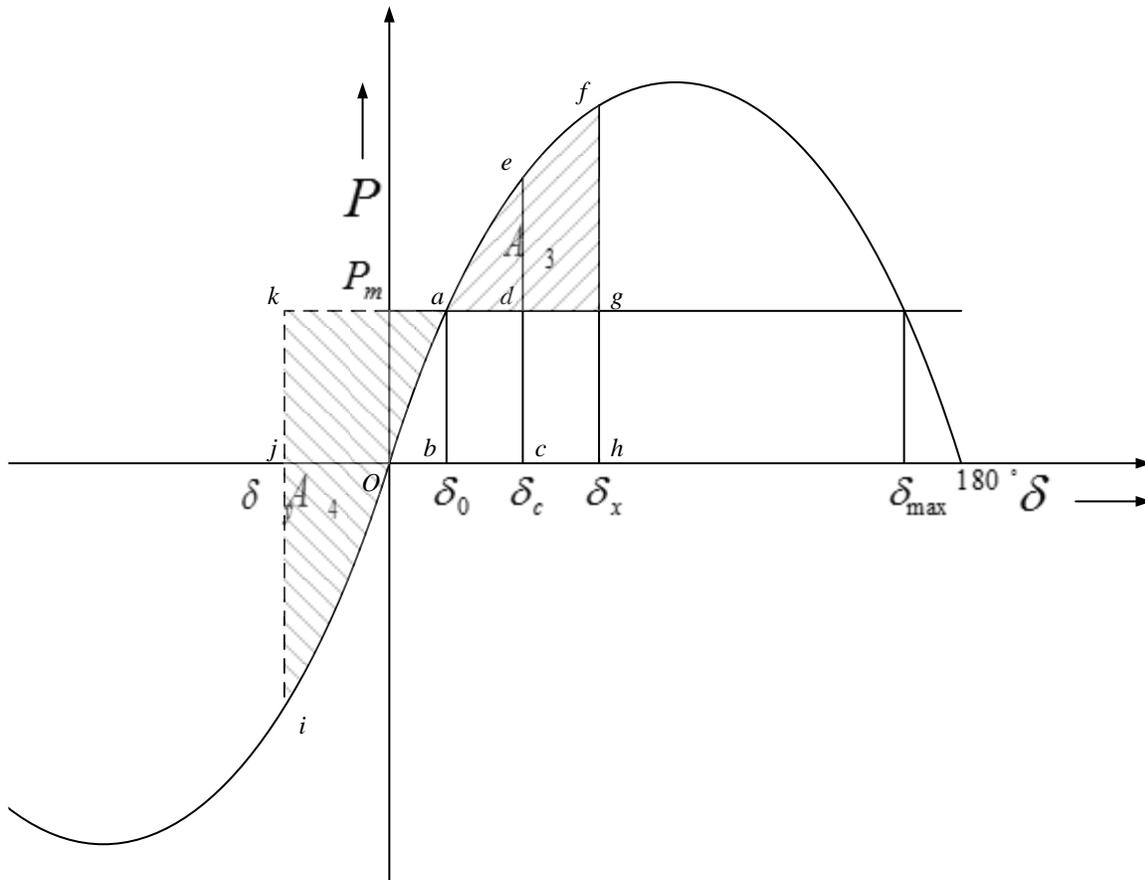
FIG.-4.3 POWER ANGLE CURVE FOR THE GENERATOR (EXTENDED CASE)
